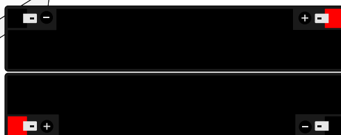
Disposición de las baterías.
